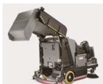
Meccanismo idraulico di svuotamento
