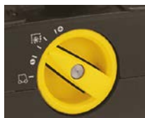
Pressione Rulli spazzola regolabile
