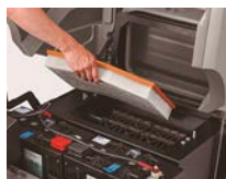
Grande filtro in poliestere con sistema di pulizia manuale
