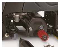
I rulli si sostituiscono con grande facilità
