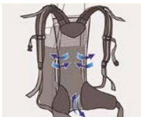
Imbracatura ergonomica, abbate le vibrazioni e previene il surriscaldamento della schiena
