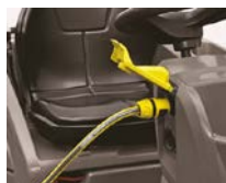
Risciacquo automatico serbatoio
