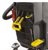
Pressione della testata spazzole regolabile
