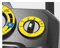
Selettore diametro tubo di aspirazione
